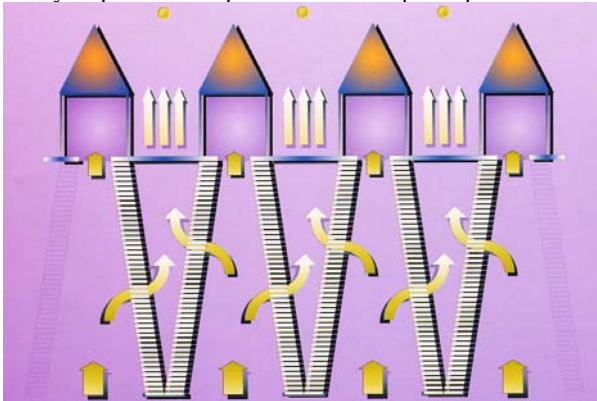
Рис. 6 Схема работы BOU AAF AS. Проход воздуха через фильтры.
