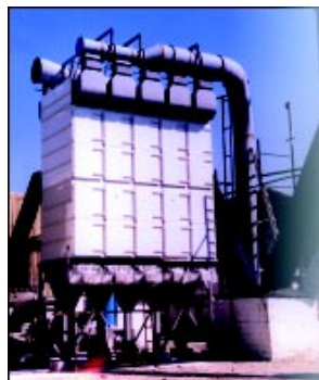
Применение фильтров на печи для выплавки свинца.
