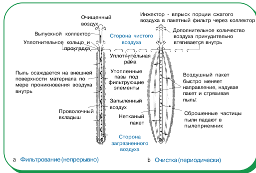
Вид уплотнительной рамы и двух фильтрующих элементов в разрезе, где показан принцип работы.
